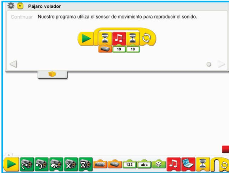
El programa del Pájaro volador no se modifica, pero se añade un programa que utiliza el sensor de movimiento. El nuevo programa espera a que el pico del pájaro active el sensor de movimiento y reproduce el Sonido 19, el sonido del trino, y espera un segundo. El programa se repite. Ambos programas de los ejemplos de Construir y Continuar pueden funcionar al mismo tiempo.
